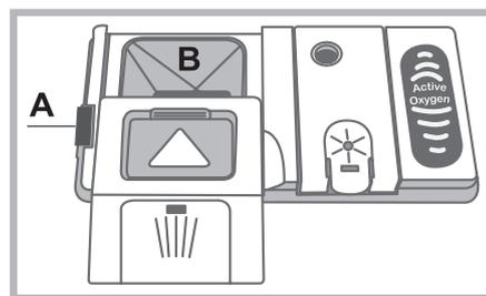
**Introdurre il detersivo solo nella vaschetta "B" asciutta. La quantità di detersivo adibita al prelavaggio, deve essere posizionata direttamente in vasca.**
