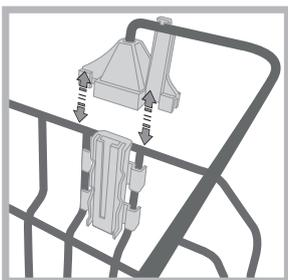
Il cesto superiore è regolabile in altezza a seconda della necessità: in posizione alta quando nel cesto inferiore si vogliono sistemare stoviglie ingombranti; in posizione bassa, in modo da sfruttare gli spazi delle ribaltine o dei reclinabili creando più spazio verso l'alto.
